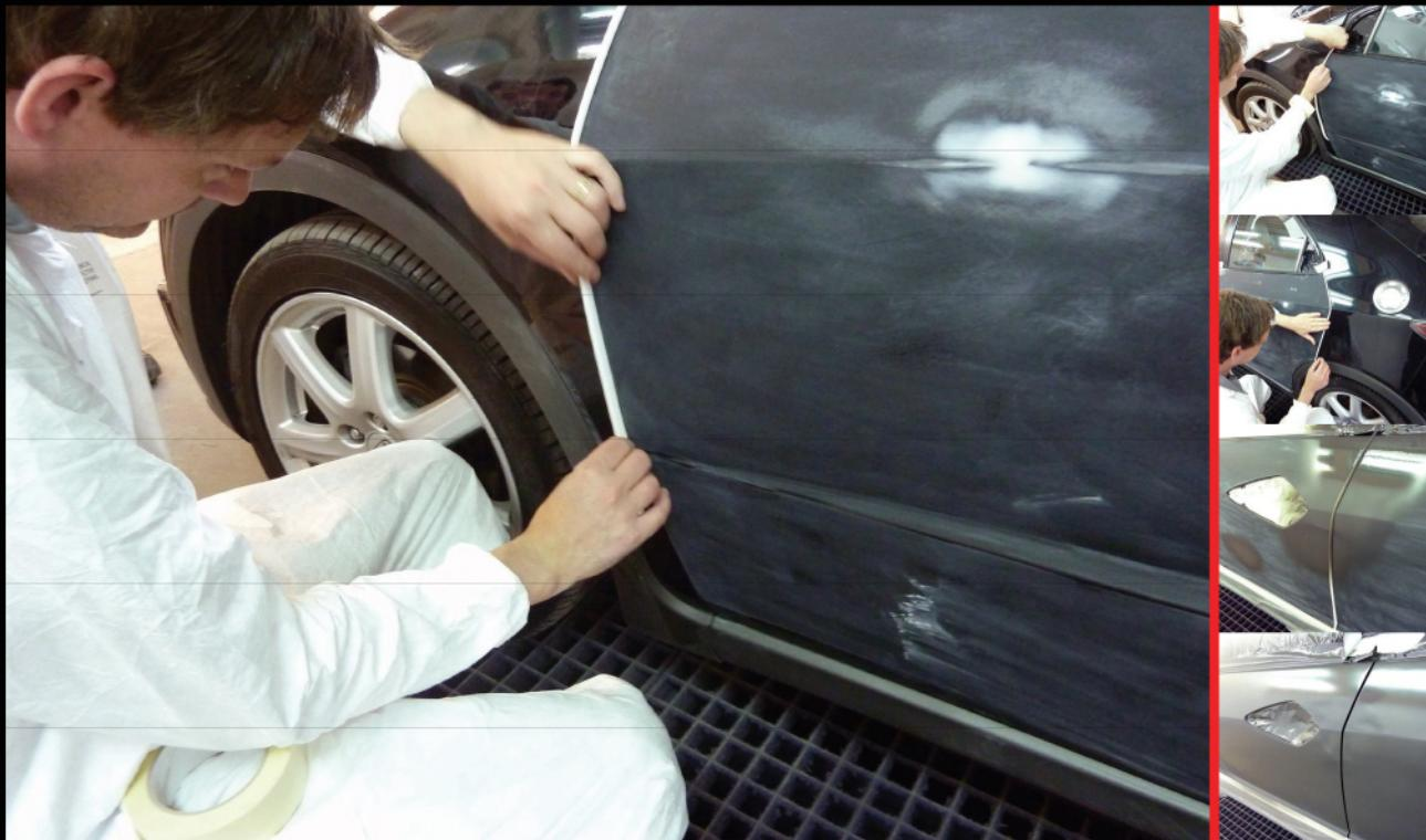
Легко и эффективно маскирует проемы крыльев, капота, дверей и багажника.
