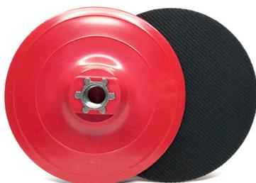
Подложка для абразивных дисков позволяет быстро производить их замену на шлифовальной машинке. Крючки на подложке надежно удерживают диск с велкро при обработке поверхности. Жесткая основа подложки позволяет увеличить нагрузку на шлифовальный диск и тем самым повысить производительность съема обрабатываемого материала.
