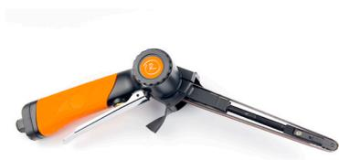
Пневматический шлифовальный напильник рассчитан на работу с бесконечными абразивными лентами. Применяется для шлифования и зачистки поверхностей в труднодоступных местах, а также удаления точечной сварки. Для повышения комфорта работы оснащен такими функциями: регулировка угла наклона рукоятки, изоляция от холода и режим плавного пуска.
