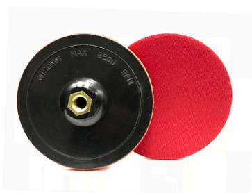
Оправки изготовлены из высококачественного пластика, выбранного в соответствии с требованиями к весу, стабильности и износоустойчивости, что позволяет свести до минимума вибрацию во время работы. Возможно применение на промышленных угловых шлифовальных машинах с регулятором числа оборотов или на малооборотных шлифовальных машинах с резьбой M14.
