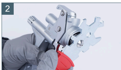
Затяните дюзу при помощи универсального ключа
